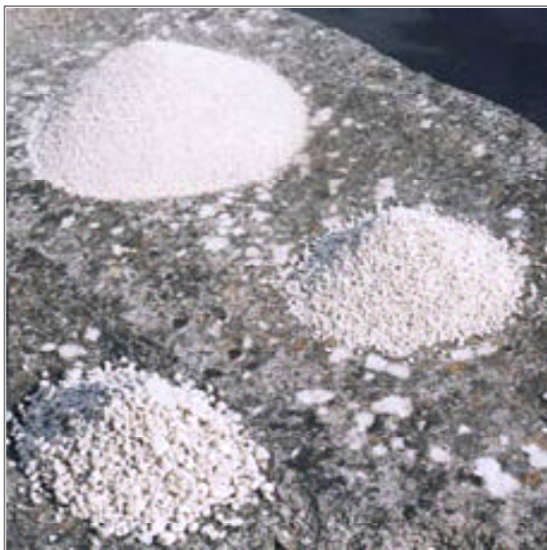
48 - Mortier pilé et tamisé pour évaluer la proportion de grains fins, moyens et gros.
